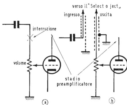
Fig. 5 - Esempio delle modifiche da apportare nel circuito di bassa frequenza di un ricevitore per l'inserzione del dispositivo « Select-o-Ject ».
