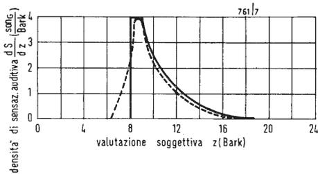
Fig. 5 - Curva di mascheramento (linea tratteggiata) per una nota pura di 1 kHz, avente l'intensità sonora di 13 son<sub>G</sub>. La curva a tratto continuo è un'approssimazione, che fornisce buoni risultati nelle misure di sensazione auditiva, come è stato comprovato. L'area sottesa da ciascuna delle due curve è di 13 son<sub>G</sub>.
