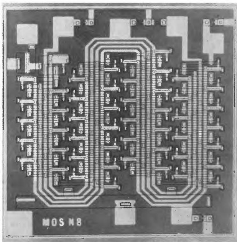
Fotografia di uno shift register dinamico Philips a 25 bit. Le dimensioni reali sono di qualche mm<sup>2</sup>.
