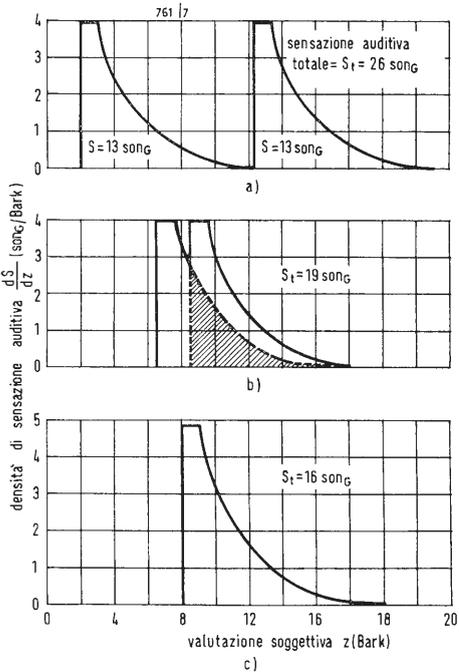
Fig. 6 - Effetto di mascheramento quando due suoni sono fortemente spaziali in frequenza (a), quando le loro curve di mascheramento si sovrappongono (b) e quando i due suoni incidono nella stessa banda critica, ma sono incoerenti (c).
