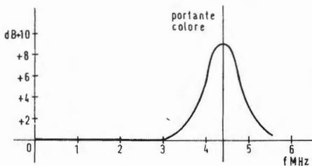
Fig. 4 - Risposta in frequenza per la correzione dei circuiti per la regolazione del segnale di colore nel ricevitore. Con questa correzione si compensa l'attenuazione indicata in fig. 2.
