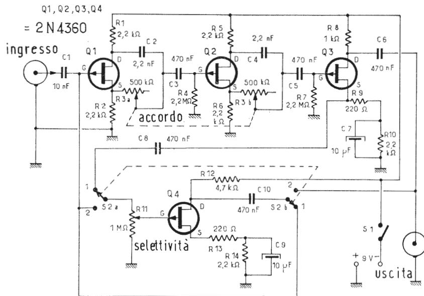
Fig. 3 - Schema pratico del dispositivo « Select-o-Ject ».
